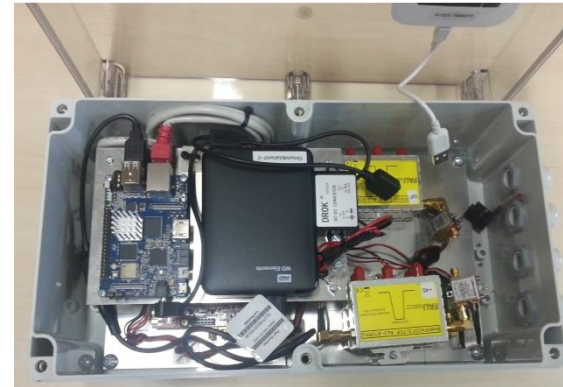
BS-Empfängerschaltung in Gehäuse (BananaPi als Stationsrechner, HDD, LNA, Filter)
